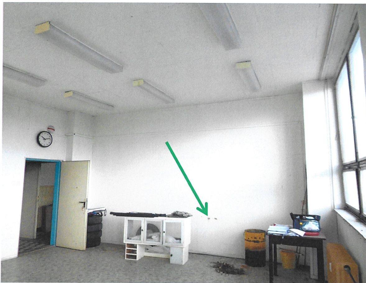
Foto č. 3 – Lokalizace místa odběru vzorku č. 1. Dvoupodlažní část VB, 2.NP, m.č. 233 (č.d. 28). Bezazbestové obkladové desky jako zateplení povrchu přiček a stropu.
